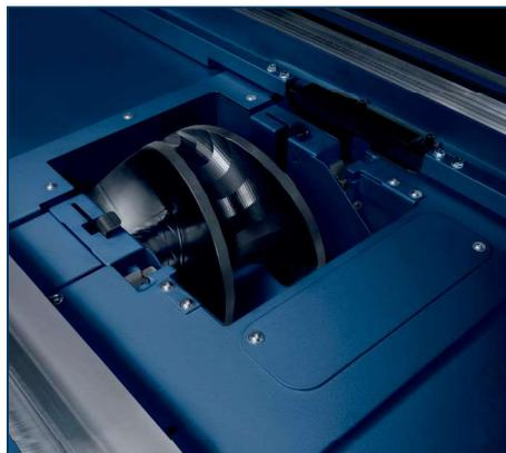
Die Stufenrollen (mit seitlicher Führung) stellen sich automatisch auf die verwendeten Durchmesser ein.
