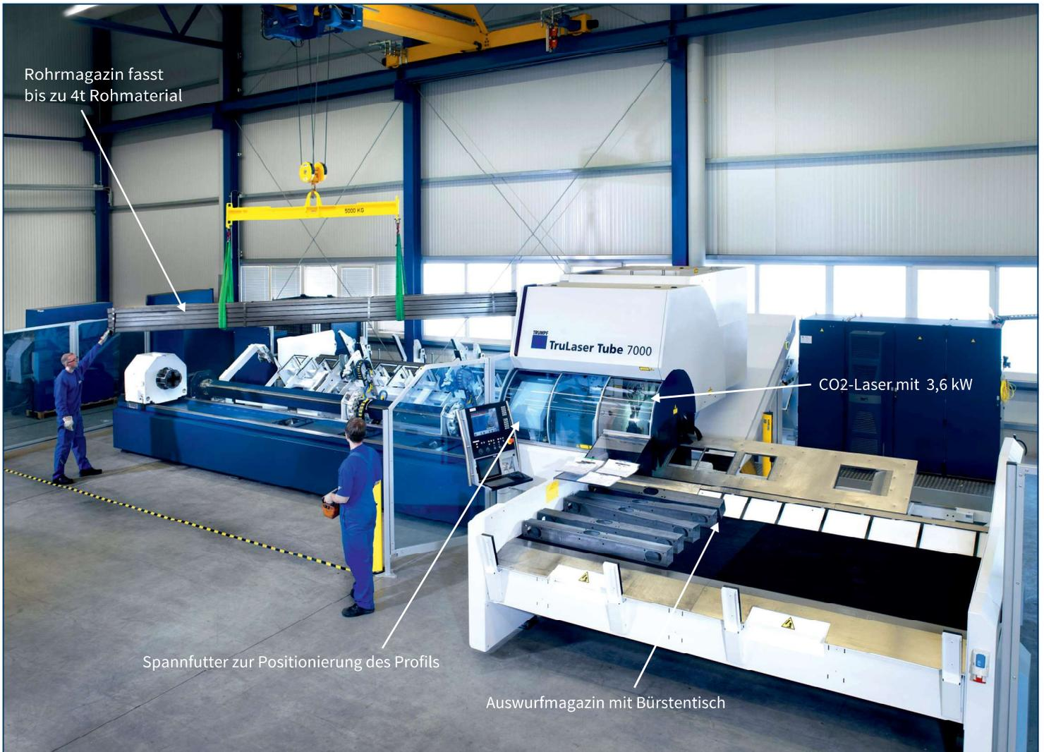
Rohrmagazin fasst bis zu 4t Rohmaterial
